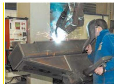
Instalación de soldadura robotizada
