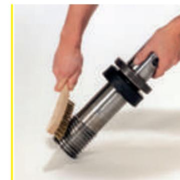
... kann das Gewindeteil herausgedreht werden.
